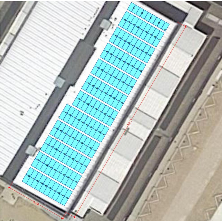
Figura 13. Distribució panells fotovoltaics de la instal·lació
